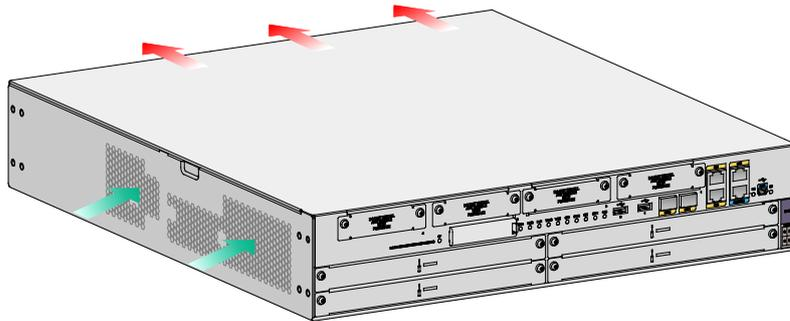
图1-3 R3900-04-G 散热方式示意图
