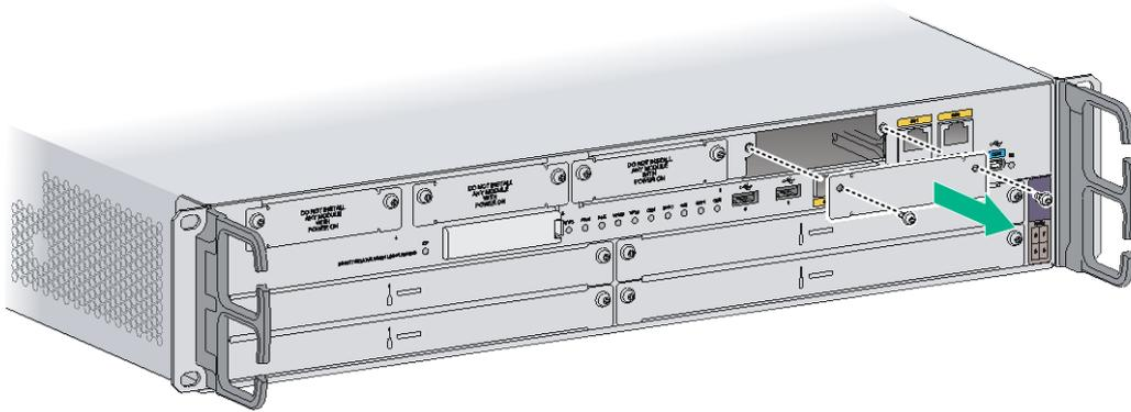
图2-17 安装 SIC 接口模块
