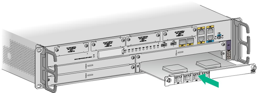
(3) 顺时针旋紧松不脱螺钉，将接口模块固定在设备上。
