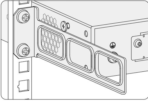
图2-11 安装后挂耳当设备深度小于机架深度
