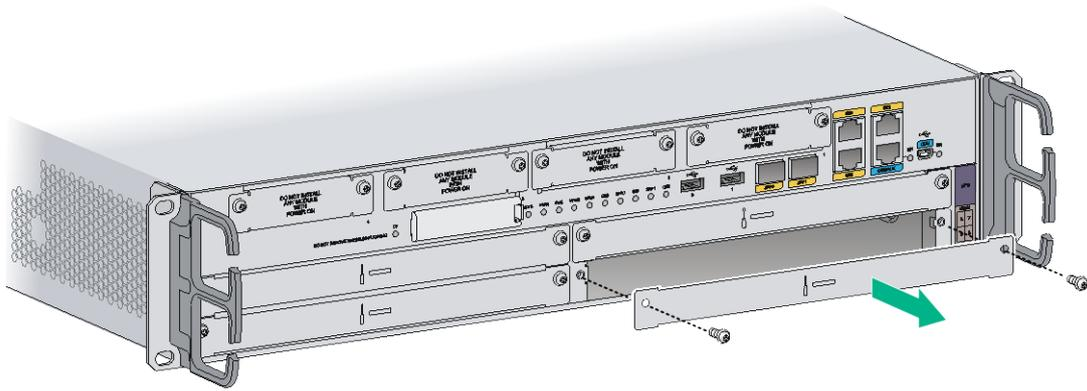
图2-19 安装 HMIM 接口模块
