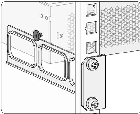
(5) 将左、右前挂耳分别用螺钉固定到设备前面板的左右两侧，并顺时针拧紧。
