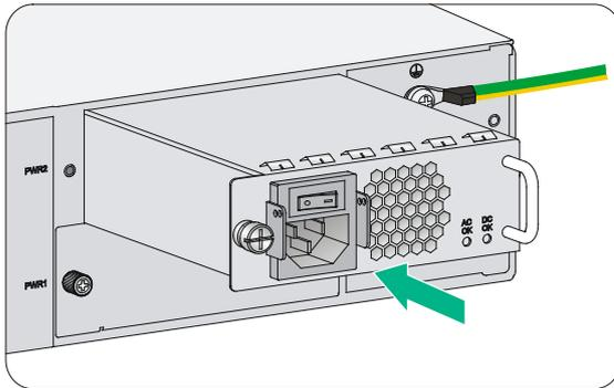
图2-26 安装直流电源模块
